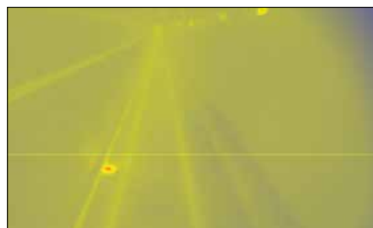
Exemplo de terceiro trilho quente detectado pelo Sistema de Imagem Térmica (THIS) da ENSCO
